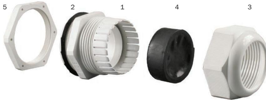
Сальник состоит из корпуса (1), уплотнителя (4), гайки уплотнения (3), прокладки (2) и фиксирующей гайки (5). Уплотнитель и прокладка выполнены из неопрена.
