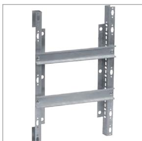
Съемная монтажная рама обеспечивает удобство и простоту сборки, возможность производить монтаж вне корпуса. DIN-рейки установлены с шагом 125 мм. Для удобства прокладки кабеля увеличено расстояние между задней стенкой и DIN-рейками.
