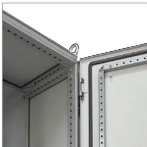
Сборная конструкция на основе каркаса из профилей замкнутого сечения обеспечивает высокую нагрузочную способность шкафа. На монтажную панель – 500 кг. На дверь – 50 кг. На боковую / заднюю панель – 50 кг. На каркас (на внутренних рейках) – 1 600 кг.
