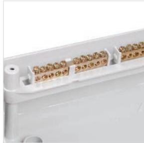
Съемный держатель шин N и PE можно устанавливать как вверх, так и вниз корпуса на специальные крепления. Сами же шины N и PE устанавливаются на съемный держатель простым защелкиванием в посадочные места.
