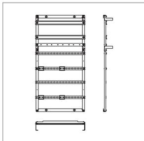
Съемная монтажная рама в корпусах ЩЭ-Х-1 и ЩЭ LIGHT. В ЩЭ-Х-1 можно устанавливать счетчики как на три точки крепления, так и на DIN-рейку. В ЩЭ LIGHT – на DIN-рейку.
