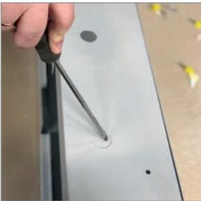
Наличие выбивных отверстий на боковых поверхностях ускоряет процесс монтажа.
