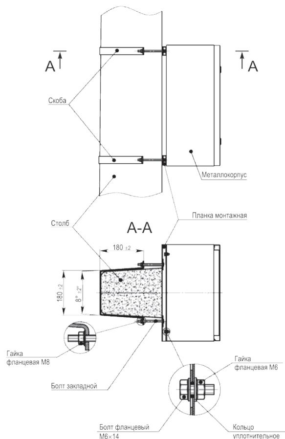
Схема крепления корпуса к столбу монтажной полосой
